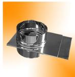
Круглые шиберы выглядят в виде металлического кармана, внутри которого поступательно перемещается заслонка. Шиберы используются для регулирования потока воздуха, проходящего через воздуховоды. Кроме того шибер может использоваться в качестве заглушки во время запуска вентилятора для предотвращения перегрузки его электродвигателя.
